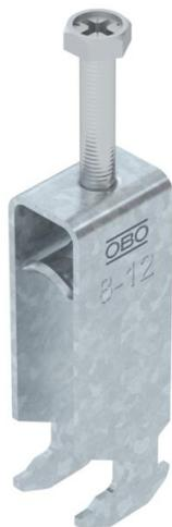
Staffa reggicavo con base a testa di martello, coppa in metallo con bordi arrotondati per la protezione del cavo. Per il montaggio verticale e orizzontale di 3 cavi singoli su profilato a C. Per dimensioni dell'asola di 16 - 17 mm. Con una vite sulla coppa premente, testa della vite esagonale universale da SW10, a taglio e a croce. Per il montaggio in ambienti interni ed esterni. Più cavi dovrebbero essere separati da coppe doppie. Si consiglia di utilizzare una controcoppa.
