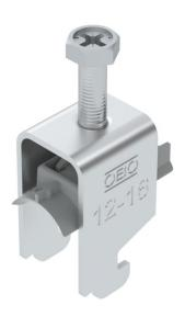
Bride de fixation avec pied N, plaque de pression en matière plastique en polypropylène. Pour montage vertical et horizontal d'1 câble individuel sur des rails profilés en C. Pour une ouverture de 11 – 12 mm. Avec vis à 1 filet sur plaque de pression, tête de vis hexagonale universelle SW10, avec fente et empreinte cruciforme. Convient au montage en intérieur et en extérieur. L'utilisation d'une contre-plaque est recommandée.
