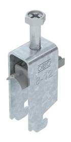
Bügelschelle mit N-Fuß, Kunststoffdruckwanne aus Polypropylen. Zur vertikalen und horizontalen Montage von 2 Einzelkabeln an C-Profilschiene. Für Schlitzweite 11 - 12 mm. Mit 1-gängiger Schraube an Druckwanne, universeller Sechskant-Schraubenkopf SW10, mit Schlitz und Kreuzschlitz. Geeignet für Montage im Innen-und Außenbereich. Mehrere Kabel sollten durch Doppelwannen getrennt werden. Der Einsatz einer Gegenwanne wird empfohlen.
