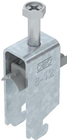
Bride de fixation avec pied N, plaque de pression en matière plastique en polypropylène. Pour montage vertical et horizontal de 2 câbles individuels sur des rails profilés en C. Pour une ouverture de 11 – 12 mm. Avec vis à 1 filet sur plaque de pression, tête de vis hexagonale universelle SW10, avec fente et empreinte cruciforme. Convient au montage en intérieur et en extérieur. Plusieurs câbles doivent être séparés par des plaques doubles. L'utilisation d'une contre-plaque est recommandée.
