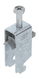
Staffa reggicavo con base a N, coppa in plastica di polipropilene. Per il montaggio verticale e orizzontale di 2 cavi singoli su profilato a C. Per dimensioni dell'asola di 11 - 12 mm. Con una vite sulla coppa premente, testa della vite esagonale universale da SW10, a taglio e a croce. Per il montaggio in ambienti interni ed esterni. Più cavi dovrebbero essere separati da coppe doppie. Si consiglia di utilizzare una controcoppa.
