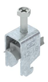
Bügelschelle mit N-Fuß, Kunststoffdruckwanne aus Polypropylen. Zur vertikalen und horizontalen Montage von 2 Einzelkabeln an C-Profilschiene. Für Schlitzweite 11 - 12 mm. Mit 1-gängiger Schraube an Druckwanne, universeller Sechskant-Schraubenkopf SW10, mit Schlitz und Kreuzschlitz. Geeignet für Montage im Innen-und Außenbereich. Mehrere Kabel sollten durch Doppelwannen getrennt werden. Der Einsatz einer Gegenwanne wird empfohlen.
