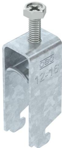
Bügelshelle mit N-Fuß, Metalldruckwanne mit gerundeten Kanten für Kabelschutz. Zur vertikalen und horizontalen Montage von 2 Einzelkabeln an C-Profilshiene. Für Schlitzweite 11 - 12 mm. Mit 1-gängiger Schraube an Druckwanne, universeller Sechskant-Schraubenkopf SW10, mit Schlitz und Kreuzschlitz. Geeignet für Montage im Innen- und Außenbereich. Mehrere Kabel sollten durch Doppelwannen getrennt werden. Der Einsatz einer Gegenwanne wird empfohlen.
