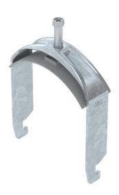
Bride de fixation avec pied U, plaque de pression en matière plastique en polypropylène. Pour montage vertical et horizontal d'1 câble individuel sur des rails profilés en C. Pour une ouverture de 18 – 22 mm. Avec vis à 1 filet sur plaque de pression, tête de vis hexagonale universelle SW10, avec fente et empreinte cruciforme. Convient au montage en intérieur et en extérieur. L'utilisation d'une contre-plaque est recommandée.
