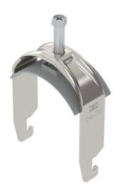
Staffa reggicavo con base a U, coppa in plastica di polipropilene. Per il montaggio verticale e orizzontale di 1 cavo singolo su profilato a C. Per dimensioni dell'asola di 18 - 22 mm. Con una vite sulla coppa premente, testa della vite esagonale universale da SW10, a taglio e a croce. Per il montaggio in ambienti interni ed esterni. Si consiglia di utilizzare una controcoppa.
