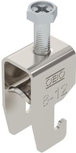
Bride de fixation avec pied U, plaque de pression en métal avec bords arrondis pour la protection des câbles. Pour montage vertical et horizontal d'1 câble individuel sur des rails profilés en C. Pour une ouverture de 18 – 22 mm. Avec vis à 1 filet sur plaque de pression, tête de vis hexagonale universelle SW10, avec fente et empreinte cruciforme. Convient au montage en intérieur et en extérieur. L'utilisation d'une contre-plaque est recommandée.
