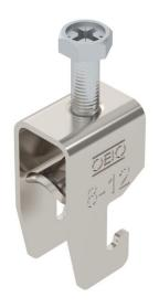
Staffa reggicavo con base a U, coppa in metallo con bordi arrotondati per proteggere il cavo. Per il montaggio verticale e orizzontale di 1 cavo singolo su profilato a C. Per dimensioni dell'asola di 18 - 22 mm. Con una vite sulla coppa premente, testa della vite esagonale universale da SW10, a taglio e a croce. Per il montaggio in ambienti interni ed esterni. Si consiglia di utilizzare una controcoppa.
