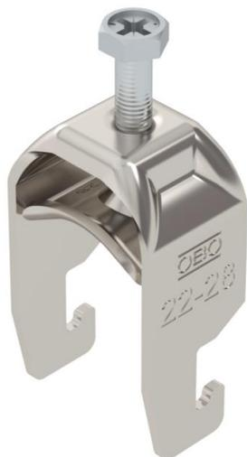
Bride de fixation avec pied U, plaque de pression en métal avec bords arrondis pour la protection des câbles. Pour montage vertical et horizontal d'1 câble individuel sur des rails profilés en C. Pour une ouverture de 18 – 22 mm. Avec vis à 1 filet sur plaque de pression, tête de vis hexagonale universelle SW10, avec fente et empreinte cruciforme. Convient au montage en intérieur et en extérieur. L'utilisation d'une contre-plaque est recommandée.
