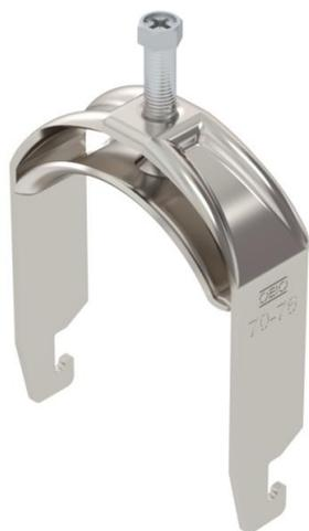
Bride de fixation avec pied U, plaque de pression en métal avec bords arrondis pour la protection des câbles. Pour montage vertical et horizontal d'1 câble individuel sur des rails profilés en C. Pour une ouverture de 18 – 22 mm. Avec vis à 1 filet sur plaque de pression, tête de vis hexagonale universelle SW10, avec fente et empreinte cruciforme. Convient au montage en intérieur et en extérieur. L'utilisation d'une contre-plaque est recommandée.
