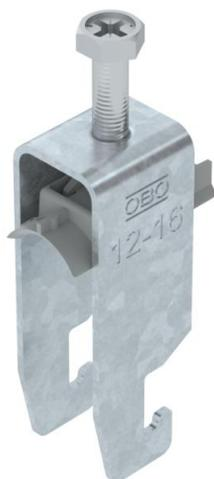
Bügel­schelle mit U-Fuß, Kunststoffdruckwanne aus Polypropylen. Zur vertikalen und horizontalen Montage von 2 Einzelkabeln an C-Profilschiene. Für Schlitzweite 18 - 22 mm. Mit 1-gängiger Schraube an Druckwanne, universeller Sechskant-Schraubenkopf SW10, mit Schlitz und Kreuzschlitz. Geeignet für Montage im Innen- und Außenbereich. Mehrere Kabel sollten durch Doppelwannen getrennt werden. Der Einsatz einer Gegenwanne wird empfohlen.
