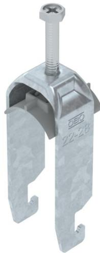
Bride de fixation avec pied U, plaque de pression en matière plastique en polypropylène. Pour montage vertical et horizontal de 2 câbles individuels sur des rails profilés en C. Pour une ouverture de 18 – 22 mm. Avec vis à 1 filet sur plaque de pression, tête de vis hexagonale universelle SW10, avec fente et empreinte cruciforme. Convient au montage en intérieur et en extérieur. Plusieurs câbles doivent être séparés par des plaques doubles. L'utilisation d'une contre-plaque est recommandée.
