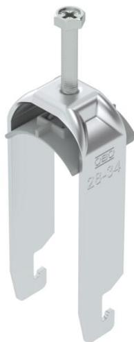
Staffa reggicavo con ancoraggio tipo U, coppa in plastica in polipropilene. Per il montaggio verticale e orizzontale di 2 cavi singoli su profilato a C. Per dimensioni scanalatura di 18-22 mm. Con coppa di pressione, testa a vite esagonale universale SW10, intaglio a croce e a taglio. Per il montaggio in ambienti interni ed esterni. Separazione tra due cavi grazie alla coppa doppia. Si raccomanda l'uso della controcoppa.
