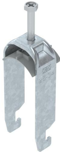
Bride de fixation avec pied U, plaque de pression en matière plastique en polypropylène. Pour montage vertical et horizontal de 2 câbles individuels sur des rails profilés en C. Pour une ouverture de 18 – 22 mm. Avec vis à 1 filet sur plaque de pression, tête de vis hexagonale universelle SW10, avec fente et empreinte cruciforme. Convient au montage en intérieur et en extérieur. Plusieurs câbles doivent être séparés par des plaques doubles. L'utilisation d'une contre-plaque est recommandée.
