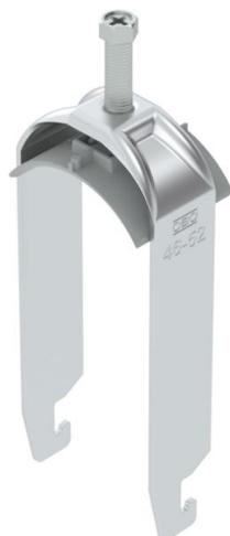
Bügelshelle mit U-Fuß, Kunststoffdruckwanne aus Polypropylen. Zur vertikalen und horizontalen Montage von 2 Einzelkabeln an C-Profilschiene. Für Schlitzweite 18 - 22 mm. Mit 1-gängiger Schraube an Druckwanne, universeller Sechskant-Schraubenkopf SW10, mit Schlitz und Kreuzschlitz. Geeignet für Montage im Innen- und Außenbereich. Mehrere Kabel sollten durch Doppelwannen getrennt werden. Der Einsatz einer Gegenwanne wird empfohlen.
