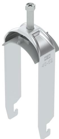
Staffa reggicavo con ancoraggio tipo U, coppa in plastica in polipropilene. Per il montaggio verticale e orizzontale di 2 cavi singoli su profilato a C. Per dimensioni scanalatura di 18-22 mm. Con coppa di pressione, testa a vite esagonale universale SW10, intaglio a croce e a taglio. Per il montaggio in ambienti interni ed esterni. Separazione tra due cavi grazie alla coppa doppia. Si raccomanda l'uso della controcoppa.
