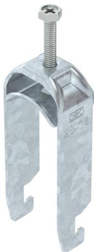
Bügelshelle mit U-Fuß, Metalldruckwanne mit gerundeten Kanten für Kabelschutz. Zur vertikalen und horizontalen Montage von 2 Einzelkabeln an C-Profil-schiene. Für Schlitzweite 18 - 22 mm. Mit 1-gängiger Schraube an Druckwanne, universeller Sechskant-Schraubenkopf SW10, mit Schlitz und Kreuzschlitz. Geeignet für Montage im Innen- und Außenbereich. Mehrere Kabel sollten durch Doppelwannen getrennt werden. Der Einsatz einer Gegenwanne wird empfohlen.
