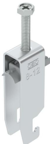
Staffa reggicavo con ancoraggio tipo U, coppa in plastica in polipropilene. Per il montaggio verticale e orizzontale di 3 cavi singoli su profilato a C. Per dimensioni scanalatura di 18-22 mm. Con coppa di pressione, testa a vite esagonale universale SW10, intaglio a croce e a taglio. Per il montaggio in ambienti interni ed esterni. Separazione tra due cavi grazie alla coppa doppia. Si raccomanda l'uso della controcoppa.
