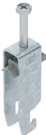
Bride de fixation avec pied U, plaque de pression en matière plastique en polypropylène. Pour montage vertical et horizontal de 3 câbles individuels sur des rails profilés en C. Pour une ouverture de 18 mm ou 22 mm. Avec vis à 1 filet sur plaque de pression, tête de vis hexagonale universelle SW10, avec fente et empreinte cruciforme. Convient au montage en intérieur et en extérieur. Plusieurs câbles doivent être séparés par des plaques doubles. L'utilisation d'une contre-plaque est recommandée.
