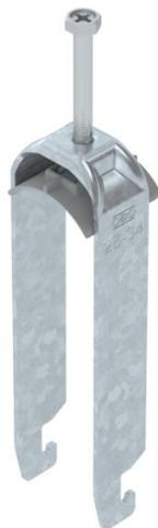
Staffa reggicavo con base a U, coppa in plastica di polipropilene. Per il montaggio verticale e orizzontale di 3 cavi singoli su profilato a C. Per dimensioni dell'asola di 18 mm o 22 mm. Con una vite sulla coppa premente, testa della vite esagonale universale da SW10, a taglio e a croce. Per il montaggio in ambienti interni ed esterni. Più cavi dovrebbero essere separati da coppe doppie. Si consiglia di utilizzare una controcoppa.
