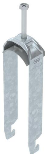
Bügelshelle mit U-Fuß, Kunststoffdruckwanne aus Polypropylen. Zur vertikalen und horizontalen Montage von 3 Einzelkabeln an C-Profilshiene. Für Schlitzweite 18 mm oder 22 mm. Mit 1-gängiger Schraube an Druckwanne, universeller Sechskant-Schraubenkopf SW10, mit Schlitz und Kreuzschlitz. Geeignet für Montage im Innen- und Außenbereich. Mehrere Kabel sollten durch Doppelwannen getrennt werden. Der Einsatz einer Gegenwanne wird empfohlen.
