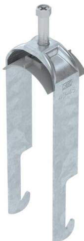
Staffa reggicavo con base a W, coppa in plastica di polipropilene. Per il montaggio verticale e orizzontale di 2 cavi singoli su profilati angolari fino a < 40 mm. Con una vite sulla coppa premente, testa della vite esagonale universale da SW10, a taglio e a croce. Per il montaggio in ambienti interni ed esterni. Più cavi dovrebbero essere separati da coppe doppie. Si consiglia di utilizzare una controcoppa.
