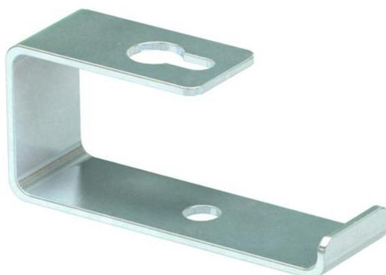
Staffa di separazione come ausilio all'installazione in caso di montaggio a soffitto del canale antincendio PYROLINE® Con D BSK, tipo BSK 091026 e tipo BSK 121026. Montaggio della staffa direttamente ai tasselli di fissaggio del canale antincendio.
