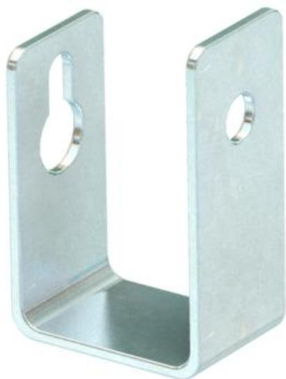
Angolare di separazione come ausilio all'installazione in caso di montaggio a parete del canale antincendio PYROLINE® Con D BSK, tipo BSK 090511 e tipo BSK 120511. Montaggio dell'angolare direttamente ai tasselli di fissaggio del canale antincendio.
