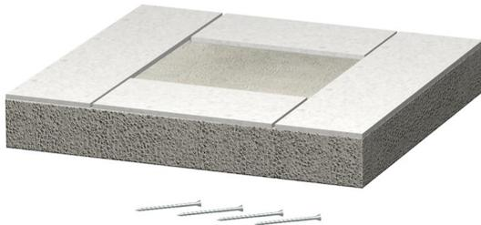
Endstück für Brandschutzkanal PYROLINE® Con S BSK bestehend aus wasser- und frostbeständigen Glasfaserleichtbeton zum Verschluss der Kanäleenden. Inklusive Senkkopfschrauben und aufgeklebten Dichtungsstreifen.
