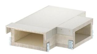
Raccordo a T per canale antincendio PYROLINE® Con S BSK I90/E30 in calcestruzzo leggero con fibra di vetro resistente all'acqua e al gelo per realizzare derivazioni a T nello sviluppo del canale. I materiali di collegamento consentono un rapido montaggio, i coperchi consentono una rapida ispezione e successiva implementazione.
