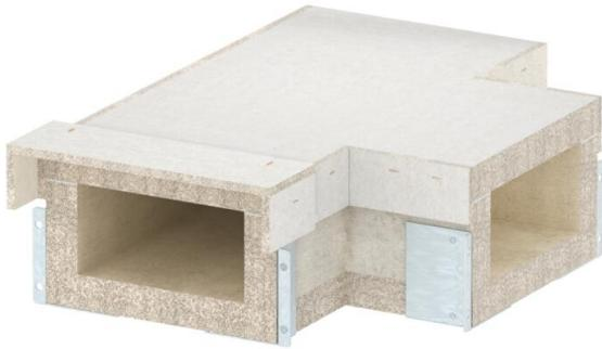
Pièce en T pour goulotte coupe-feu PYROLINE® Con S , de type BSKH09-K1021 constituée de béton léger en fibre de verre résistant à l'eau et au gel pour la conception de dérivation en T dans le sens de la goulotte. Des éclisses d'assemblage prêtes à installer permettent un assemblage rapide des éléments de conduit sur site, et les couvercles simplement posés permettent une inspection et un câblage ultérieur rapides.
