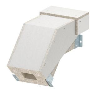
Coude vertical convexe pour goulotte coupe-feu PYROLINE® Con S, de type BSKH09-K0506 constitué de béton léger en fibre de verre résistant à l'eau et au gel pour la conception de changements de direction verticaux (45°) dans le sens de la goulotte. Des éclisses d'assemblage prêtes à installer permettent un assemblage rapide des éléments de conduit sur site, et les couvercles simplement posés permettent une inspection et un câblage ultérieur rapides.
