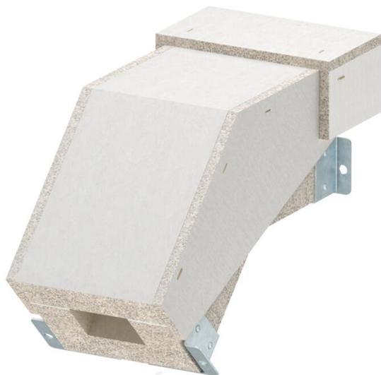
Curva verticale discendente per canale antincendio PYROLINE® Con S, tipo BSKH09-K0506 in calcestruzzo leggero con fibra di vetro resistente all'acqua e al gelo per realizzare variazioni di direzione verticali (45°) nello sviluppo del canale. I materiali di collegamento consentono un rapido montaggio, i coperchi consentono una rapida ispezione e successiva implementazione.
