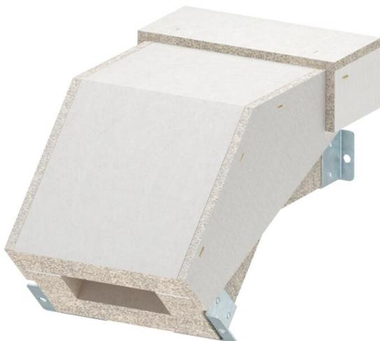
Coude vertical convexe pour goulotte coupe-feu PYROLINE® Con S, de type BSKH09-K0511 constitué de béton léger en fibre de verre résistant à l'eau et au gel pour la conception de changements de direction verticaux (45°) dans le sens de la goulotte. Des éclisses d'assemblage prêtes à installer permettent un assemblage rapide des éléments de conduit sur site, et les couvercles simplement posés permettent une inspection et un câblage ultérieur rapides.
