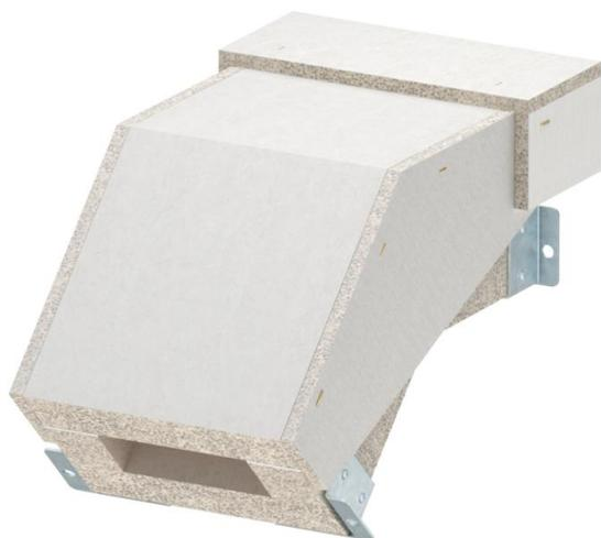
Curva verticale discendente per canale antincendio PYROLINE® Con S, tipo BSKH09-K0511 in calcestruzzo leggero con fibra di vetro resistente all'acqua e al gelo per realizzare variazioni di direzione verticali (45°) nello sviluppo del canale. I materiali di collegamento consentono un rapido montaggio, i coperchi consentono una rapida ispezione e successiva implementazione.
