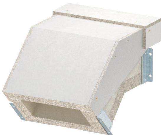
Coude vertical convexe pour goutlotte coupe-feu PYROLINE® Con S, de type BSKH09-K1021 constitué de béton léger en fibre de verre résistant à l'eau et au gel pour la conception de changements de direction verticaux (45°) dans le sens de la goutlotte. Des éclisses d'assemblage prêtes à installer permettent un assemblage rapide des éléments de conduit sur site, et les couvercles simplement posés permettent une inspection et un câblage ultérieur rapides.
