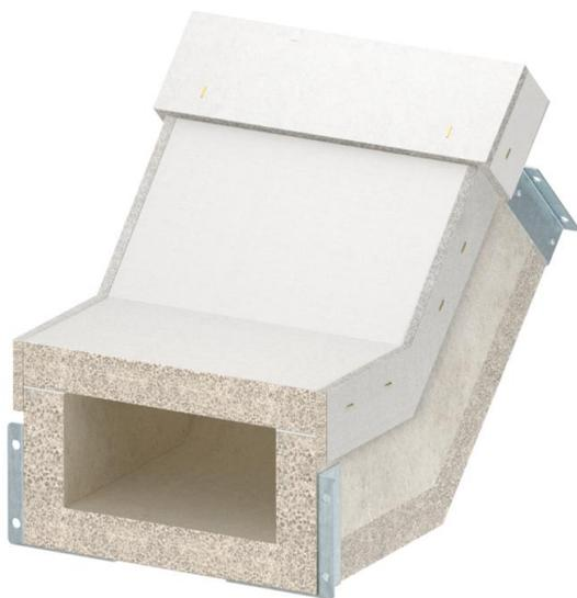
Coude vertical concave pour goutte coupe-feu PYROLINE® Con S, de type BSKH09-K1021 constitué de béton léger en fibre de verre résistant à l'eau et au gel pour la conception de changements de direction verticaux (45°) dans le sens de la goutte. Des éclisses d'assemblage prêtes à installer permettent un assemblage rapide des éléments de conduit sur site, et les couvercles simplement posés permettent une inspection et un câblage ultérieurs rapides.
