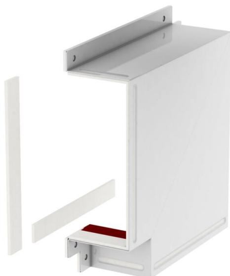
Capot d'élément préformé pour la protection de deux extrémités de câbles BSKM 0407 en angle plat pour montage direct au mur et au plafond. Inclut les joints collés pour étanchement des joints et joints lâches combinés à une plaque d'adaptation ainsi que des vis pour la liaison équipotentielle.
