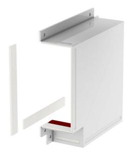
Calotta per la copertura di due estremità canale BSKM 1025 come angolare piatto con montaggio diretto a parete e a soffitto. Incluse guarnizioni incollate per la chiusura ermetica delle fughe e guarnizioni staccate con la combinazione con contropiastra e vite per l'equipotenzializzazione.
