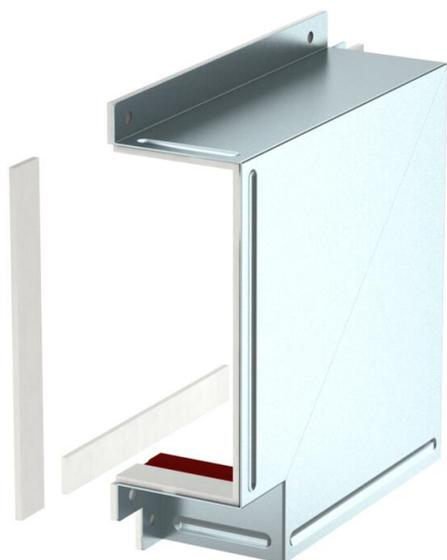
Capot d'élément préformé pour la protection de deux extrémités de câbles BSKM 0407 en angle plat pour montage direct au mur et au plafond. Inclut les joints collés pour étanchement des joints et joints lâches combinés à une plaque d'adaptation, ainsi que des vis pour la liaison équipotentielle.
