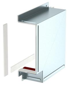
Calotta per la copertura di due estremità canale BSKM 1025 come angolare piatto con montaggio diretto a parete e a soffitto. Incluse guarnizioni incollate per la chiusura ermetica delle fughe e guarnizioni staccate con la combinazione con contropiastra e vite per l'equipotenzializzazione.
