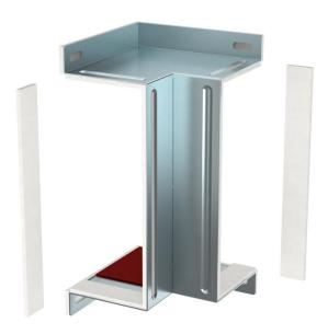
Capot d'élément pour la protection de deux extrémités de câbles BSKM 1025 en angle intérieur pour montage direct au mur ou plafond. Inclut les joints collés pour étanchement des joints et joints lâches combinés à une plaque d'adaption. ainsi que des vis pour la liaison équipotentielle.
