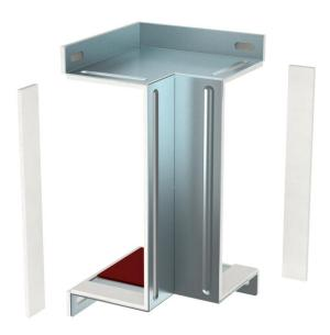
Calotta per la copertura di due estremità canale BSKM 1025 come angolo interno con montaggio diretto a parete e a soffitto. Incluse guarnizioni incollate per la chiusura ermetica delle fughe e guarnizioni staccate con la combinazione con contropiastra e vite per l'equipotenzializzazione.
