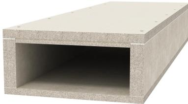
Canale antincendio in calcestruzzo leggero con fibra di vetro resistente all'acqua e al gelo della classe materiali A1 secondo la EN 13501-1 per la posa a prova d'incendio di cavi in vie di fuga e di soccorso e per il mantenimento funzionale degli impianti rilevanti per la sicurezza. Classificazione I90 come canale I secondo DIN 4102 parte 11 e classificazione E30 come canale E secondo DIN 4102 parte 12.
