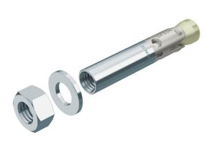
Tassello BZ-IG con filettatura interna per il fissaggio di carichi da medi a pesanti e in calcestruzzo fessurato e non fessurato. Riunisce carichi molto alti sicuri e distanza dei bordi e assiali molto ridotta. Non è necessario un taglio posteriore dei fori
