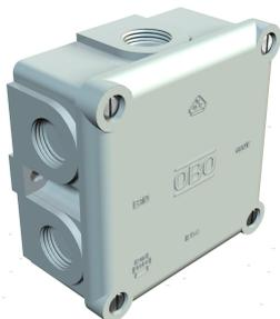
Indice de protection IP54, tension nominale 2.5 - 4 V, section nominale 2.5 - 4 en combinaison avec bornier de raccordement type 700/6 M, le boîtier a une section nominale de 4 mm<sup>2</sup>, 2 trous de montage pour des vis jusqu'à 5 mm Ø sur la face externe du boîtier. 4 vis pour couvercle, 7 entrées défonçables avec filetage M20 x 1,5,, de préférence pour presse-étoupes à filetage court.
