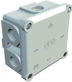
Schutzart IP54, Nennspannung 660 V, Nennquerschnitt  $2,5 \div 4$ , in Kombination mit dem Klemmstein 700/6 M hat der Kasten den Nennquerschnitt  $4 \text{ mm}^2$ , 2 Befestigungslöcher für Schrauben bis  $5 \text{ mm } \varnothing$  an der Außenseite des Kastens. 4 Deckelschrauben, 7 ausbrechbare Einführungen mit Gewinde M20 x 1,5, vorzugsweise für Kabelverschraubungen mit kurzem Anschlussgewinde. Lichte Innenmaße:  $80 \times 80 \times 39 \text{ mm}$ .
