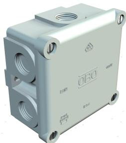
Grado di protezione IP54, tensione nominale 660 V, sezione nominale 2.5 - 4 mm<sup>2</sup>, in combinazione con la morsettiera 700/6 M la scatola ha la sezione nominale pari a 4 mm<sup>2</sup>, 2 fori di fissaggio per viti fino a 5 mm di Ø sulla parte esterna della scatola. 4 viti di copertura, 7 fori entrate cavi apribili con filettatura M20 x 1,5, preferibilmente per pressacavi aventi attacco filettato corto.
