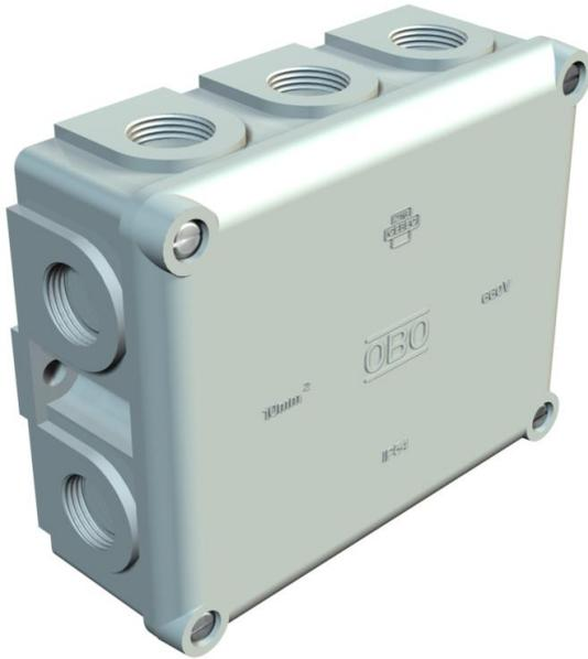
Schutzart IP54, Nennspannung 660 V, Nennquerschnitt 10 ÷ mm<sup>2</sup>, 2 Befestigungslöcher für Schrauben bis 6 mm Ø an der Außenseite des Kastens, 4 Deckelschrauben, 10 ausbrechbare Einführungen mit Gewinde M20 x 1,5, vorzugsweise für Kabelverschraubungen mit kurzem Anschlussgewinde.
