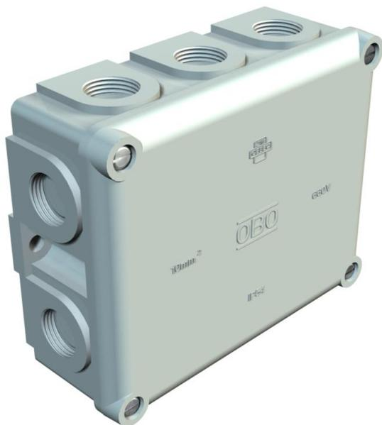
Indice de protection IP54, tension nominale 660 V, section nominale 10 - mm<sup>2</sup>, 2 trous de fixation pour vis jusqu'à 6 mm de Ø sur la face extérieure du boîtier, 4 vis pour couvercle, 10 entrées défonçables avec filetage M20 x 1,5, de préférence pour presse-étoupes à filetage court.
