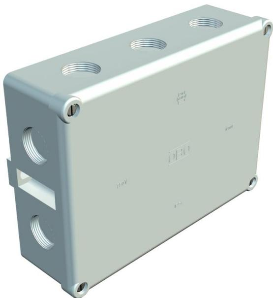
Indice de protection IP54, tension nominale 660 V, section nominale 16 - mm<sup>2</sup>, 2 trous de fixation pour des vis jusqu'à 6 mm de Ø sur la face extérieure du boîtier. 4 vis de couvercle, 10 entrées défonçables avec filetage M25 x 1,5.
